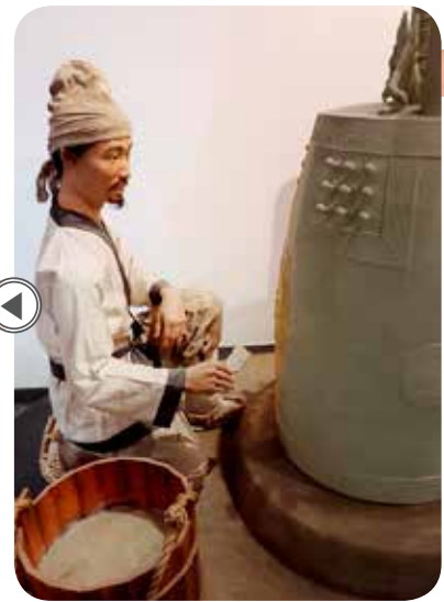
4 외형 바르기 밀랍 원형 위에 주물사(이암, 모래 등)를 여러 겹 바르고 응달에서 자연 건조시켜 외형을 완성한다.
