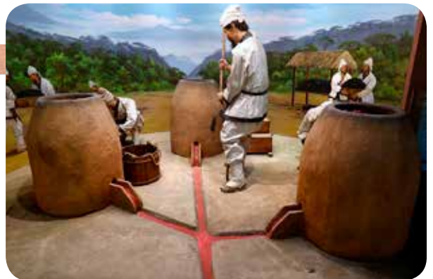
8 쇳물 붓기 내-외형의 조립이 끝나면 거푸집을 씌우고 땅속에 묻은 후 구리와 주석을 합금하여 녹인 쇳물을 붓는다.
