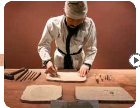
2 문양 조각하기 상대, 하대, 연곽, 당좌 등의 문양을 정교하게 조각한 뒤 밀랍으로 문양을 찍어 낸다.
